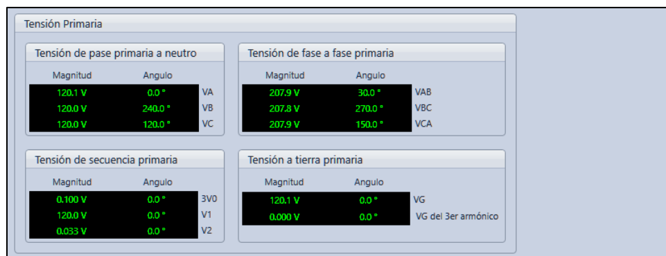
Figura 14-2. Pantalla de medición de tensión primaria
