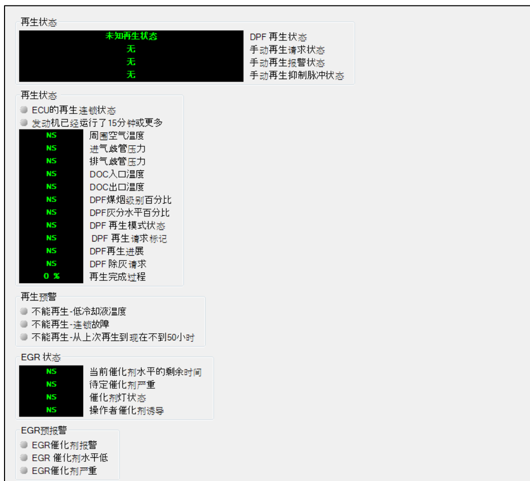
图 4-134. 测量 J1939 ECU, Yanmar 状态
