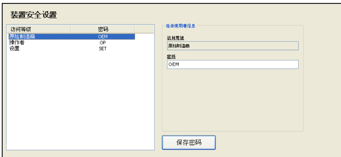
图 7-19. 设置资源管理器，一般设置，装置安全设定界面
